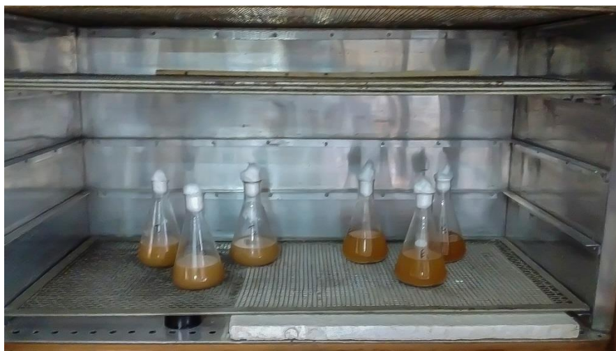
Figura 6: Orujos hidrolizados, filtrados y trasvasados, a los cuales ya se les ha adicionado la solución de levaduras y nutrientes necesaria para desencadenar correctamente el proceso fermentativo
