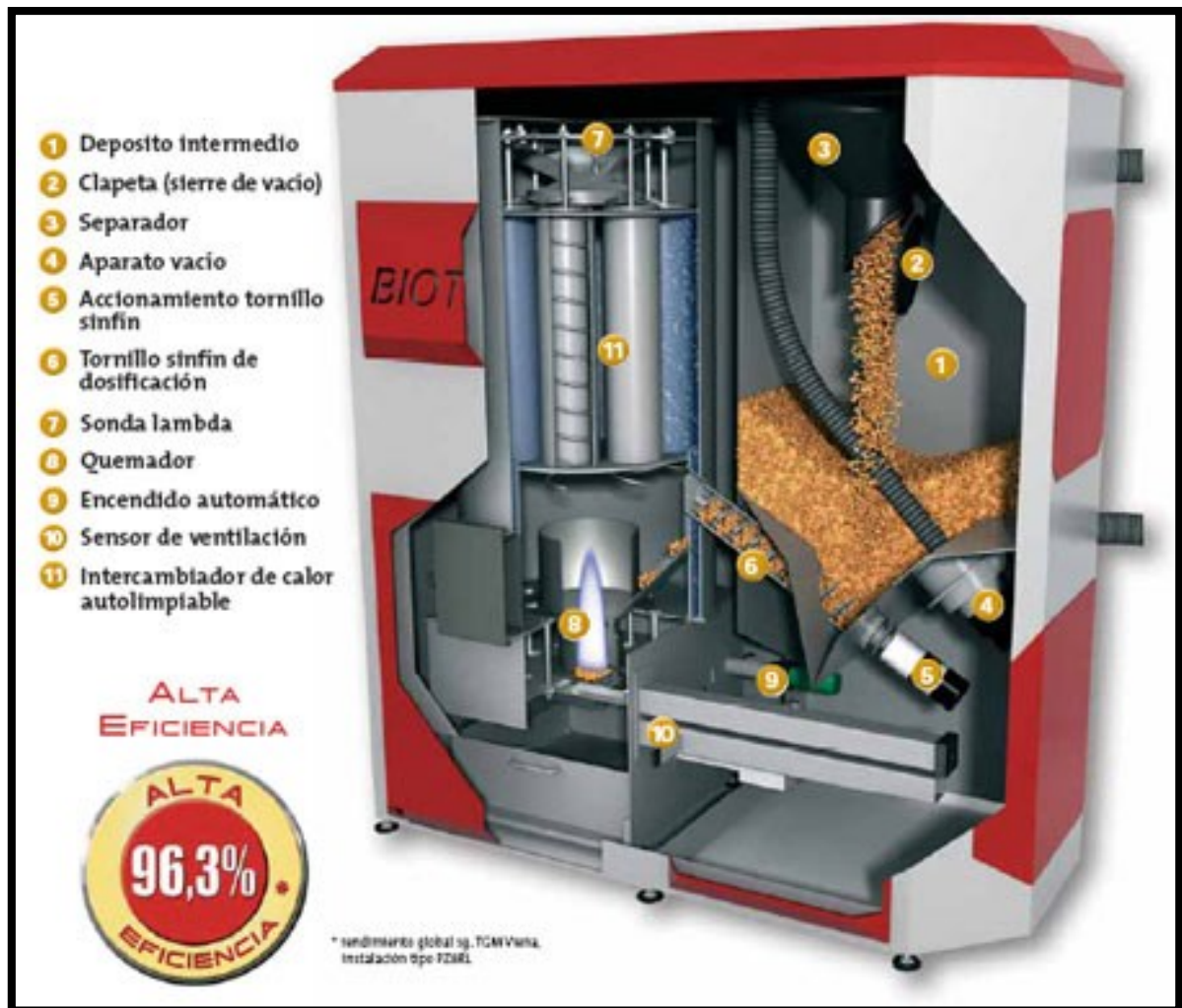
Figura 12. Esquema de una caldera comercial de biomasa de la empresa española Proingeniería.
