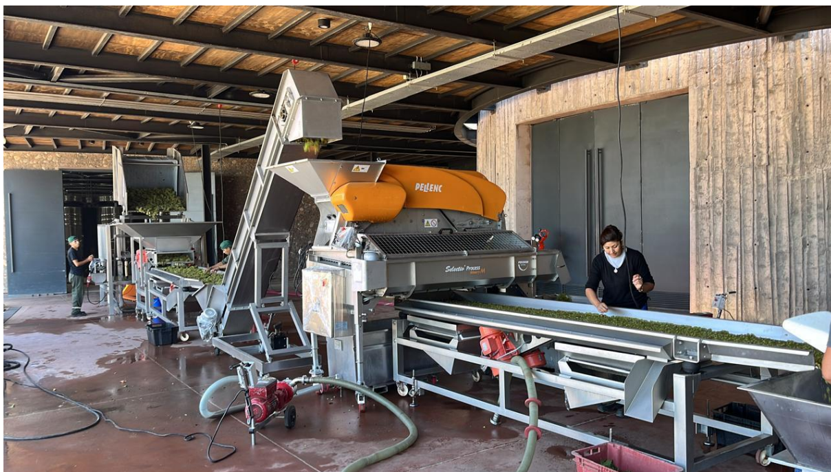
Figura 19. Línea de molienda de la bodega. Fotografía propia.
