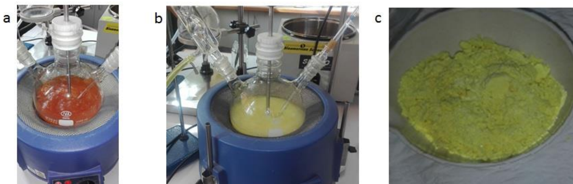
Figura 3.3: a) Síntesis de la muestra durante el proceso de envejecimiento. b) Síntesis después del proceso de envejecimiento. c) Sólido obtenido luego del filtrado.
