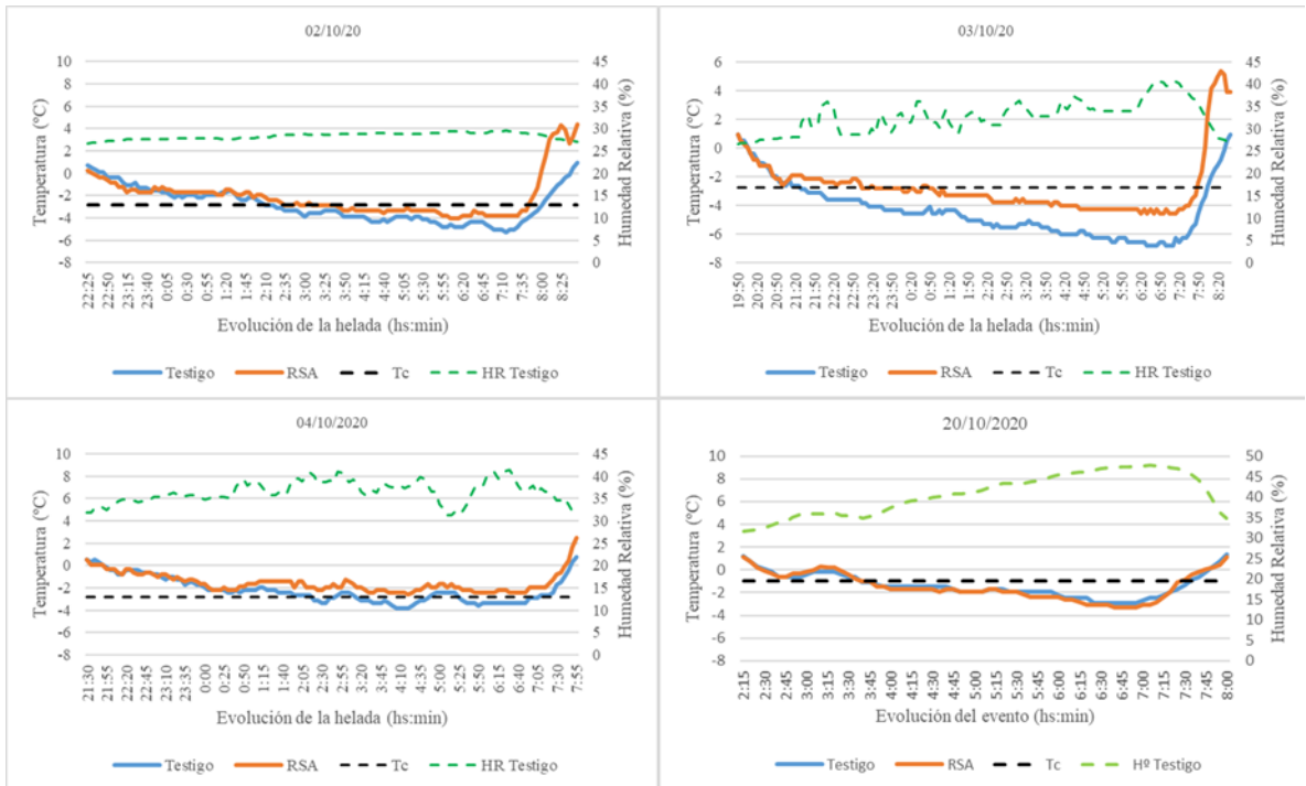
Figura 21: Temperatura promedio en °C (Testigo y RSA), Temperatura crítica que afecta el 10% de los órganos (Tc) y Humedad Relativa en porcentaje (HR) medida en el Testigo, para el Sitio 1 durante la temporada 2020.
