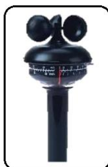
Figura 19: Anemómetro de cazoletas utilizado en el monitoreo de condiciones ambientales.
