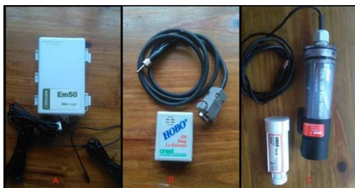
Figura 17: A) Data logger (temperatura y humedad) Decagon Em50; B) Data logger (temperatura y humedad) HOBO Familia H08; C) Data logger (temperatura y humedad) serie Pro V2 U23.
