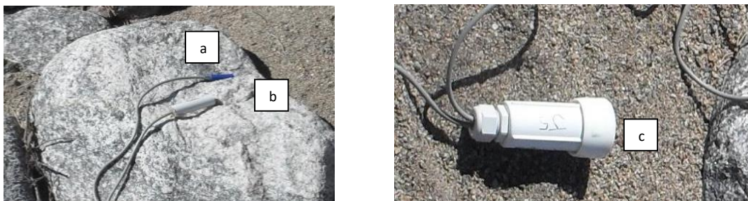
Figura 4. Modelos de PVC contruidos para estimar las temperaturas operativas del lagarto del Chaco Liolaemus chacoensis . En la figura a se puede observar el tamaño calibrado para
