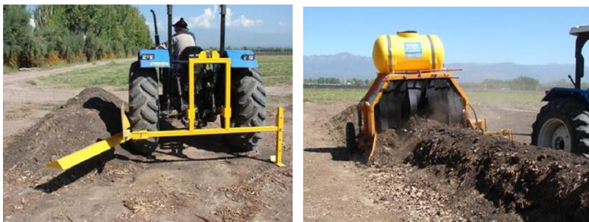
Figura 5 Mecanización del volteo de pilas de compostaje.
