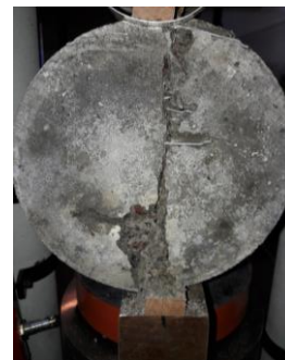
Figura 5. Rotura de la probeta ensayada por compresión diametral.
