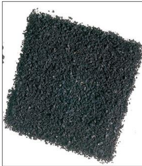
Figura 5.31. Gránulos de NFU entre 0.5-2mm.
