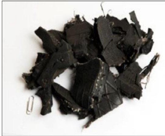
Figura 5.29. Chips de NFU entre 3-5 cm.
