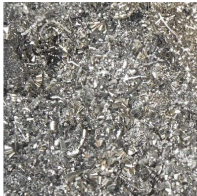
Figura 5.34. Restos de acero obtenidos en la separación magnética.
