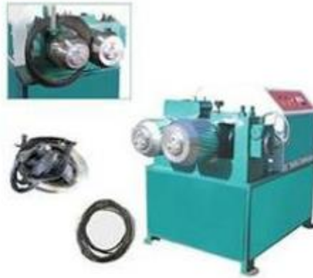
Figura 5.27. Separador del anillo de alambre.
