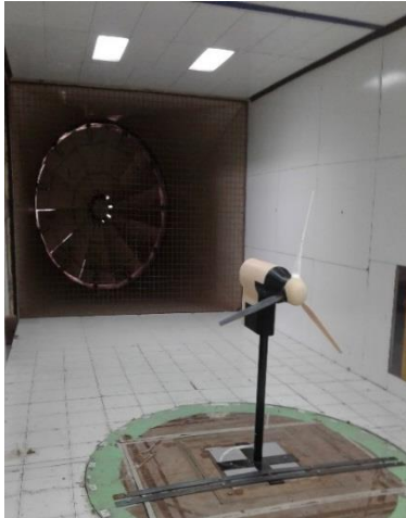
Modelo del aerogenerador montado en la sección de ensayos.
